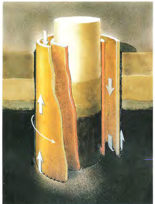
Længdesnit af et kernerør, som er ved at bore en kerne ud. Nederst løsner en diamantkronen materialet, som af boremuddret føres op til jordoverfladen. Efterhånden som diamantkronen arbejder sig nedad, glider borekernen op i inderrøret. Modhager nederst i inderrøret sikrer, at borekernen følger med op, når kernerøret trækkes op.
